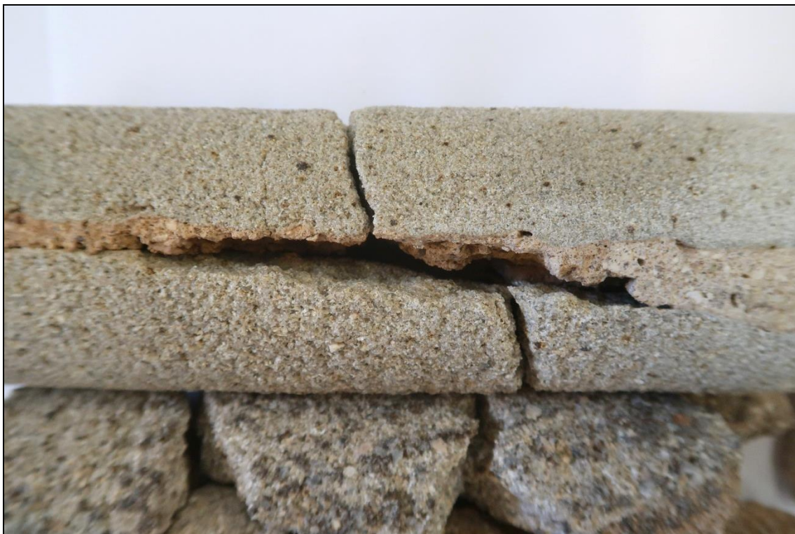
Foto 3: Detail nevyplněné spáry vývrtu V5, od čela do hloubky cca 60 malta ve spáře přítomna, dále cca 100-120 mm malta zcela chybí, zbytek spáry vyplněn
