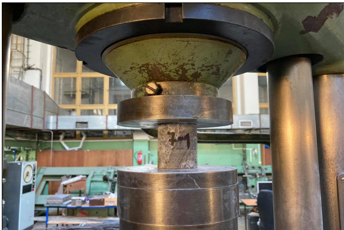
Foto 12: Zkušební těleso 7-1 (granitoid) v zatěžovacím lisu
