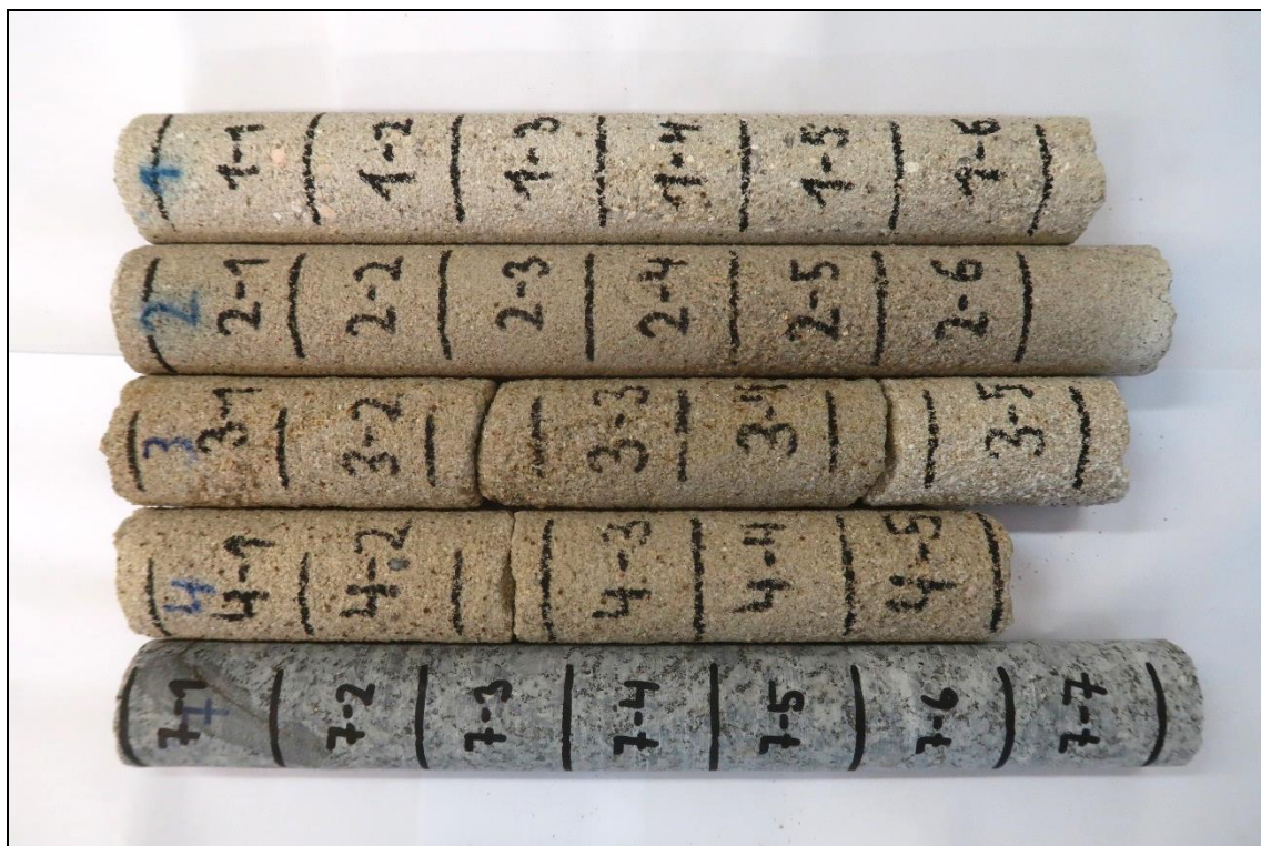
Foto 1: Pohled na vrtná jádra (V1, V2, V3, V4 a V7) Ø 50 mm odebraná z kamenů kleneb vč. označení pro přípravu zkušebních vzorků pro zkoušky v tlaku
