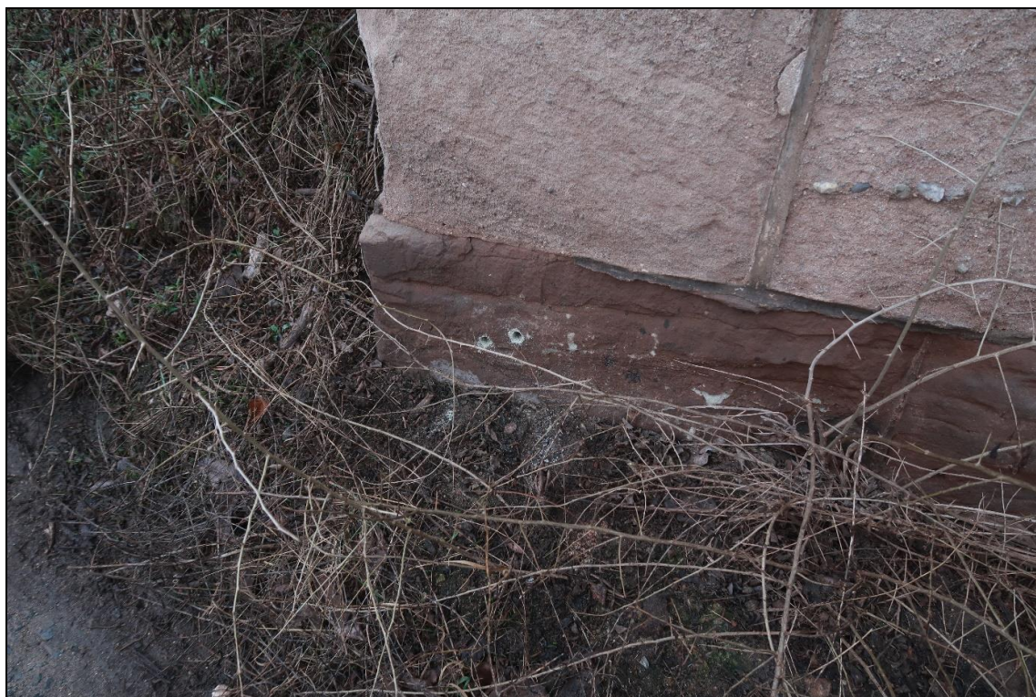
Foto 26: Odběr solí, pilíř P4, výška cca 0,25 m nad terénem, vzorek VZ2 - detail
