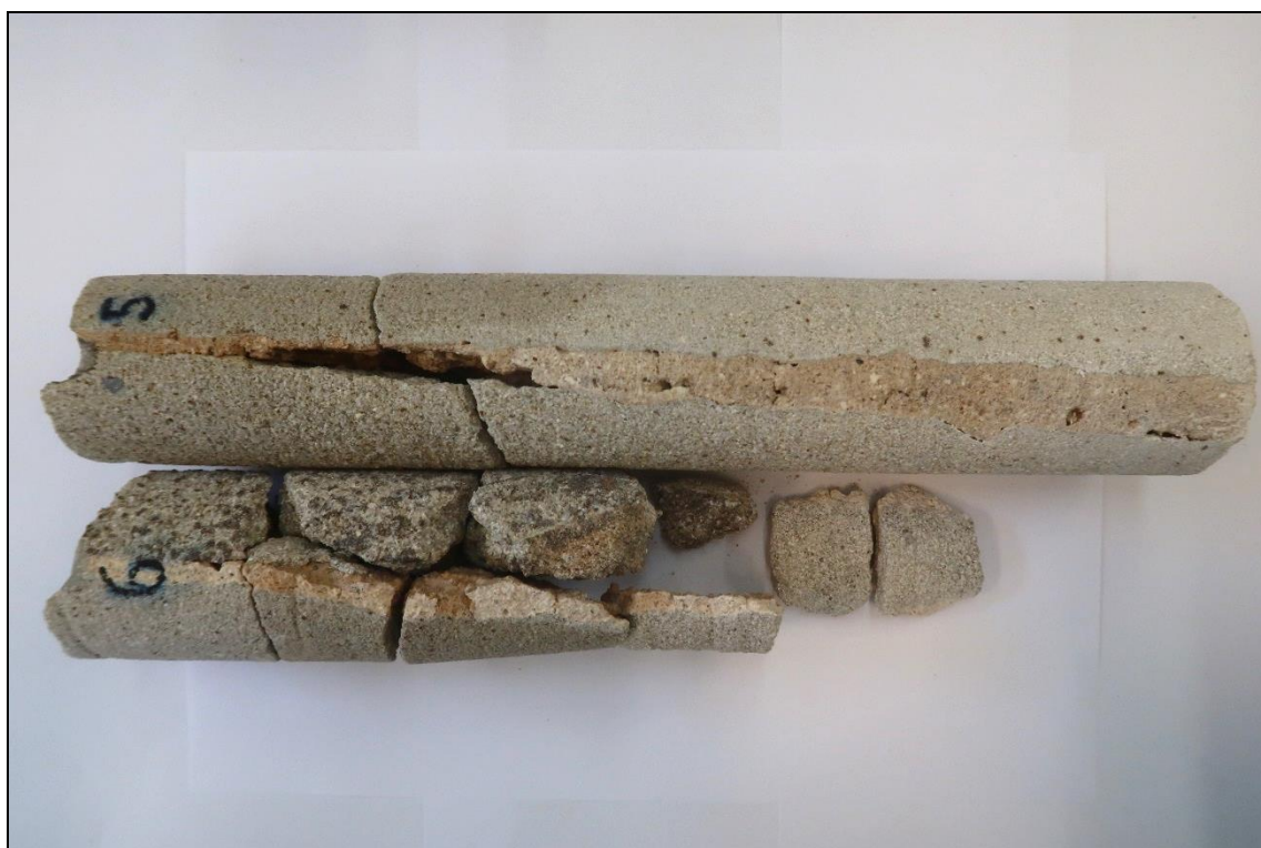
Foto 2: Pohled na vrtná jádra (V5 a V6) Ø 80 mm odebraná z ložných spár, V5 pole 5 (nad silnicí), V6 pole 2 (pole nad cestou)
