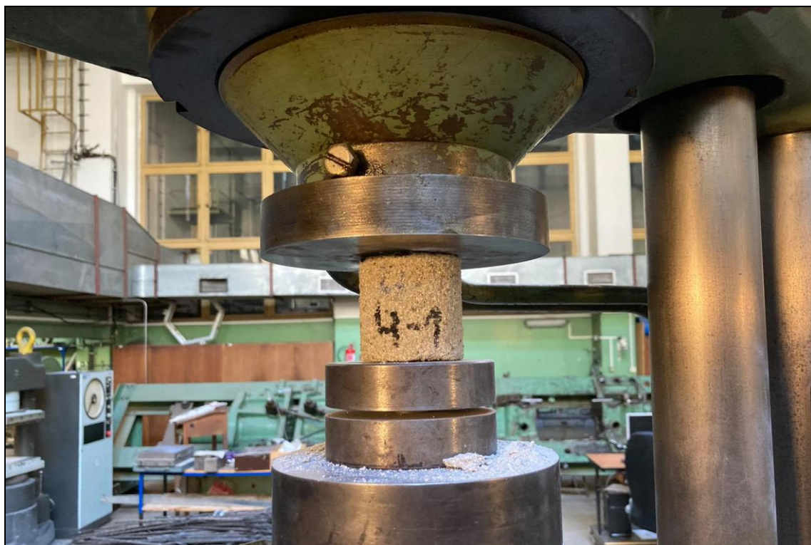
Foto 10: Zkušební těleso 4-1 (pískovec) v zatěžovacím lisu
