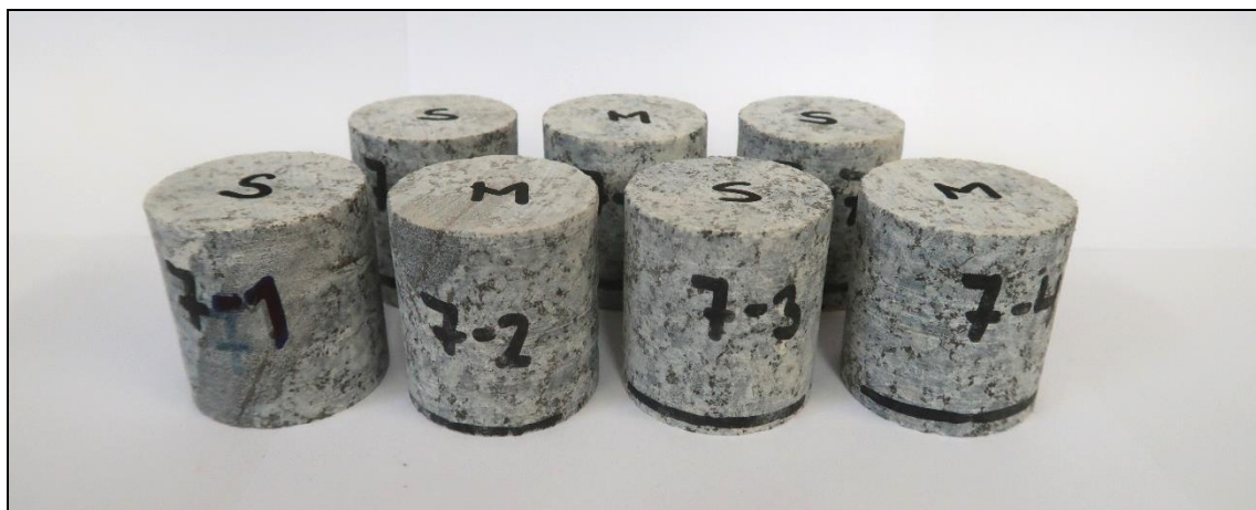
Foto 5: Pohled na připravené vzorky z vývrtnu 7 (granitoid), celkem 7 ks
