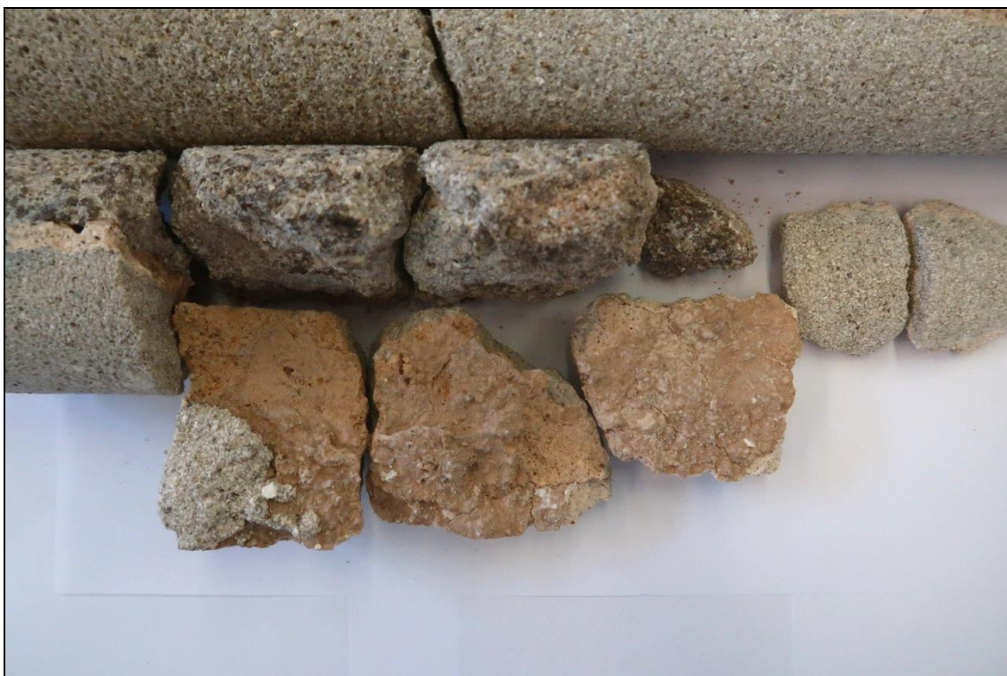
Foto 4: Detail spáry vývrtu V6, spára vyplněna částečně, část malty vyplavená ze spáry
