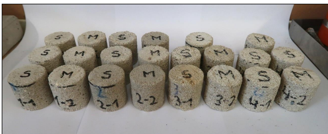
Foto 6: Pohled na připravené vzorky z vývrtnu 1, 2, 3 a 4 (sedimenty - pískovce), celkem 22 ks
