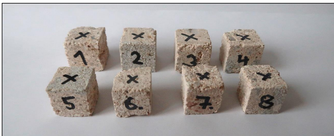
Foto 7: Vzorky malty (krychle o hraně cca 17 až 20 mm) připravené z vývrtnu V5, celkem 8 ks, malta místy pórovitá
