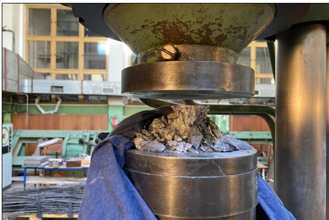
Foto 13: Zkušební těleso 7-1 (granitoid) po zkoušce v tlaku
