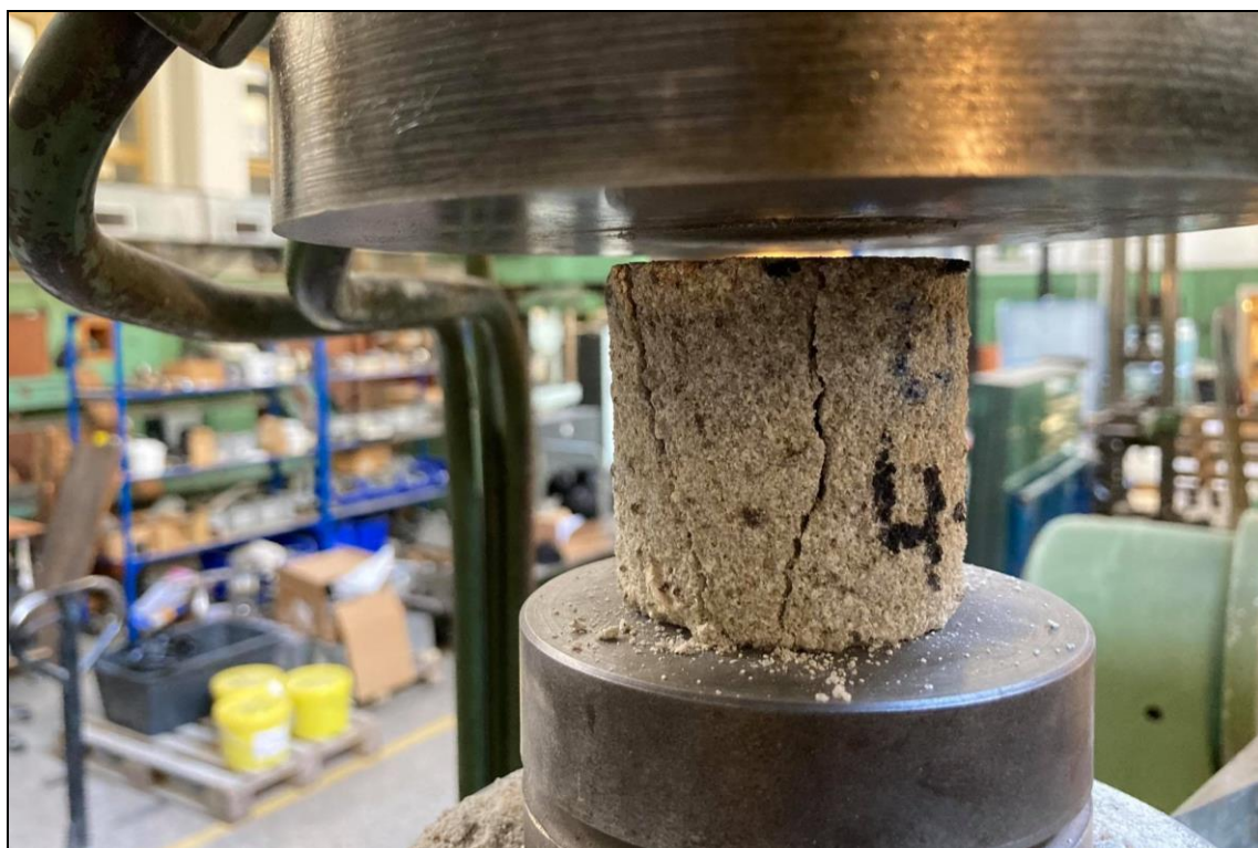
Foto 11: Zkušební těleso 4-1 (pískovec) po zkoušce v tlaku
