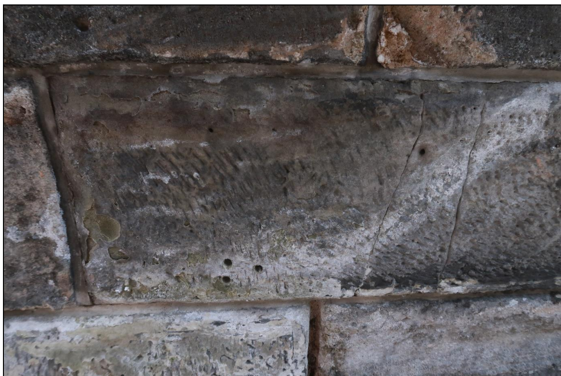
Foto 30: Odběr solí, klenba pole 2, vzorek VZ5 – detail (odběr v místě bílého výluhu)
